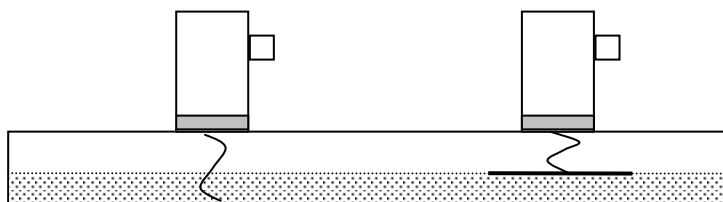
Rys. 8. Zasada badania połączeń klejonych techniką rezonansową.
